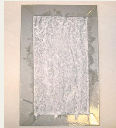
Das Lackgefüge herkömmlicher Zinklage wird durch die Weißrostbildung gestört und führt zu ausgeprägten Weißrostausbildungen. Hier ein beschichtetes Stahlblech nach 48 Stunden Salzsprühnebeltest.
