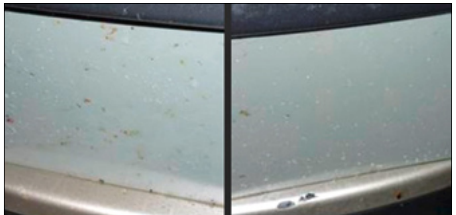
Abb. 8: Schmutzanhaftung bei Prüfblechen mit Standard-2-K PUR Oberfläche (links) und der neuen Klarlackoberfläche (rechts),
